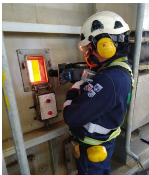
Figura 56 – Esecuzione di una analisi termografica del refrattario [32]
