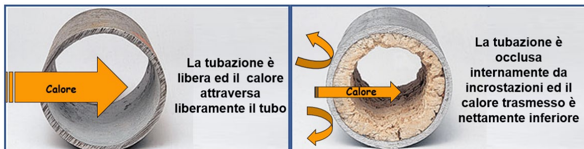
Figura 51 – Raffigurazione della differenza del flusso di calore scambiato in una tubazione pulita e incrostata internamente
