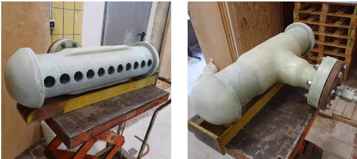
Figura 68 - Rappresentazione di parte dell'economizzatore in materiale termoplastico [40]
