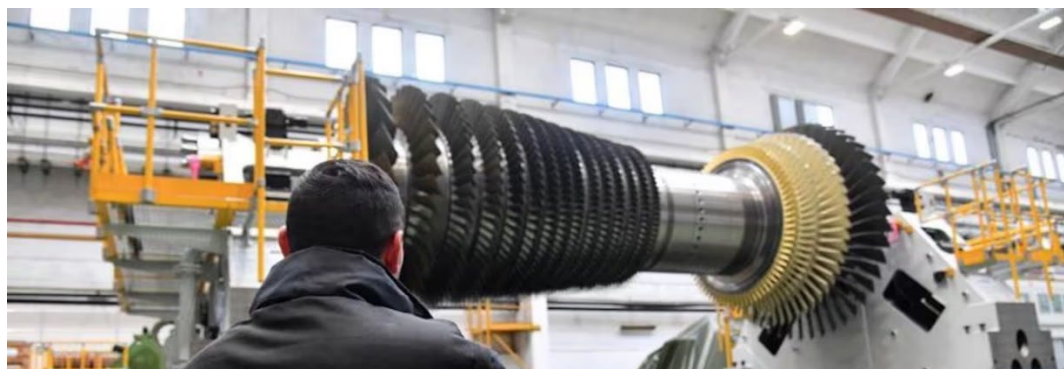
Figura 46 – Rotore con calettamento palette turbina a gas [61]
