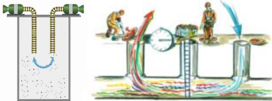
Figura 13. Esempio sistema di bonifica con un ventilatore spinge dentro aria fresca e un altro estrae i gas dall'ambiente confinato 78
