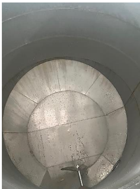
Figura 30. Interno di una tina con girante 113
