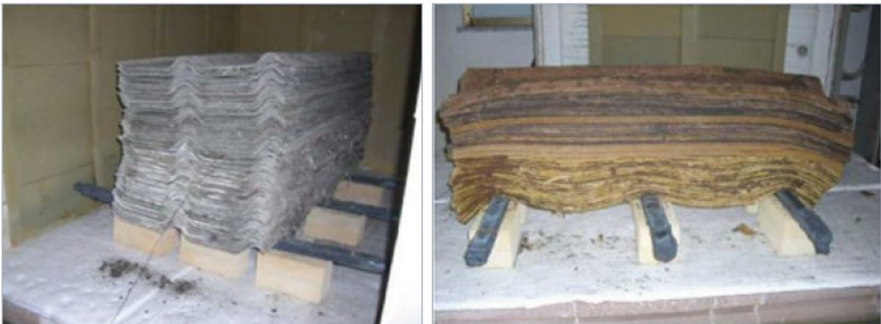
Figura 14 – Lastre in cemento-amianto prima e dopo il trattamento termico [30].
