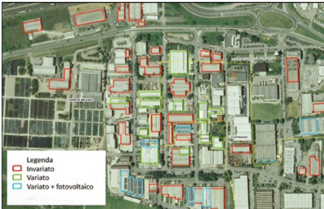
Figura 17 – Aggiornamento della mappatura delle coperture in cemento amianto [30].
